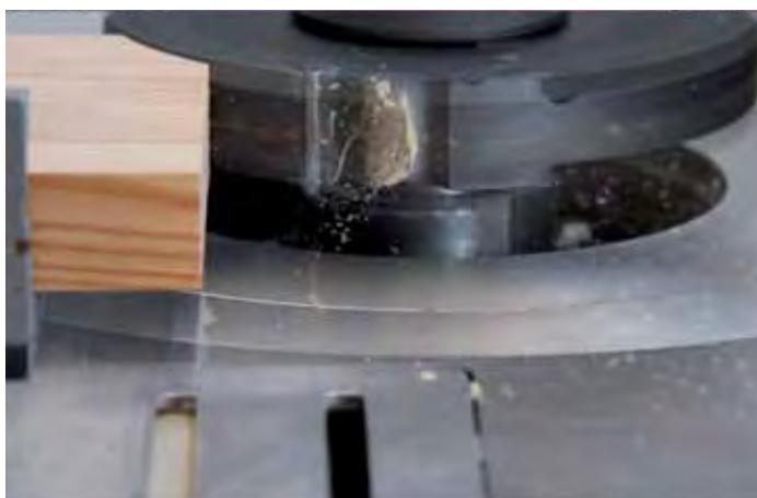
Система отводения стружки: разработана с целью оптимизации выпуска стружки.
