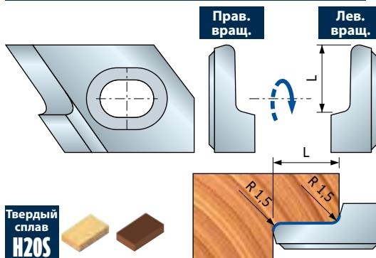
Твердый сплав H20S
