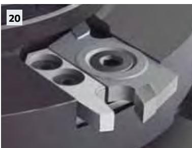
**РЕЖУЩИЕ ПЛАСТИНЫ ДЛЯ ВЫБОРКИ ПАЗОВ ПОД УПЛОТНИТЕЛЬ (IG10MD/S - IG13MD/S - РИС. 15):** изготовлены из твердого сплава и используются в производстве окон для выборки пазов под термо- и звукоизоляцию (рис. 16).
