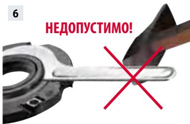
Запрещается использовать удлинители ключей или затягивать винты молотком (см. рис. 6). Не используйте переходники с отверстием, отличающимся от отверстия, предписанного конструкцией.
