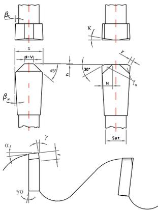
**Schnittparameter, Beispiel Stahl, Trockenschnitt, ohne Kühlschmiermittel bzw. mit Minimalmengenschmierung**
