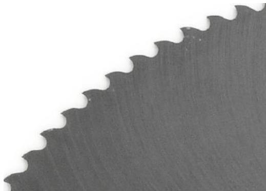
Пасивація, або обробка паром — достатньо поширений спосіб хімічної обробки поверхні диску. Характерний для цього типу покриття, чорний колір поверхні диску, отримується завдяки окисленню  $\text{CO}_2$ , яке зазнають пили під дією перегрітого ( $550^{\circ}\text{C}$ ) пару. Утворює тонку плівку з твердістю (~900 HV).
