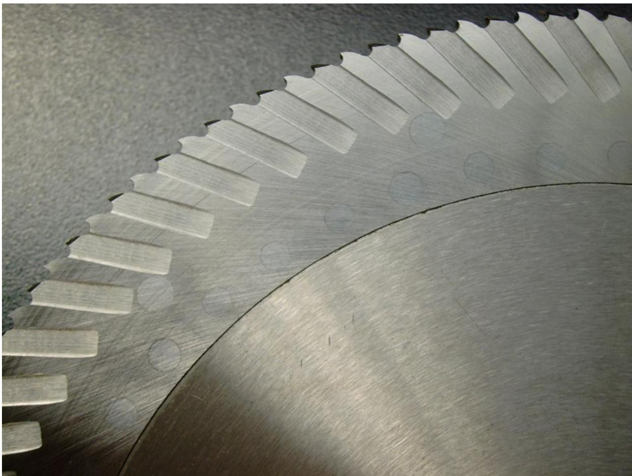
Сегментні дискові пили — спеціалізований інструмент для холодного різання сталі з границею міцності до  $800 \text{ Н}/\text{мм}^2$ . Принцип холодної обробки металів полягає у тому, що все тепло, яке виробляється при обробці, поглинається самою пилою, у той час, поки оброблюваний матеріал залишається холодним. Саме тому, наполегливо рекомендується використовувати дані пили з охолодженням.
