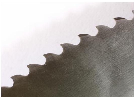
Нітрид хрому, який вкриває поверхню диску, має дуже низький коефіцієнт тертя. Саме тому, пили з покриттям CRN відмінно пристосовані для обробки матеріалів з високим абразивним, або фрикційним впливом, або тих, котрі схильні залишати наплавні шари з боків диску. Тому, оптимальною сферою застосування таких пил вважають різання кольорових металів (мідь, латунь, бронза, алюміній) з охолодженням, чи без.
