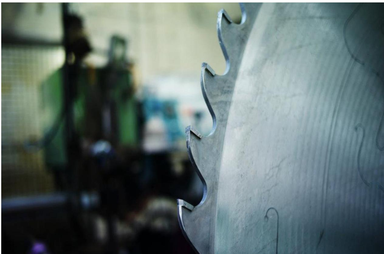
Твердосплавні дискові пили відрізняються наявністю спеціальних напайок, які кріпляться на верхівках зуба. Дані пластини виконані зі сплаву, міцнішого, ніж корпус диску, тож вони значно подовжують термін роботи інструменту.
