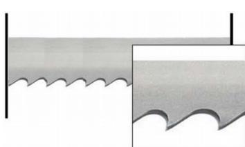
Пили з постійним кроем зуба. Характерною рисою є однакова відстань між верхівками зубців протягом усієї довжини полотна. Забезпечують чистий і якісний різ кольорових металів, та суцільних заготовок зі сталі, але не спроможні демонструвати довгий термін роботи при обробці твердих матеріалів зі змінним перетином.
